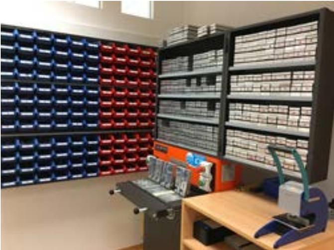
1. Die zum Prägen benötigte Presse wird auch von Alukennzeichenherstellern zum Prägen verwendet. Zum Prägen von 3D Kennzeichen sind nur spezielle Werkzeugeinsätze nötig.
