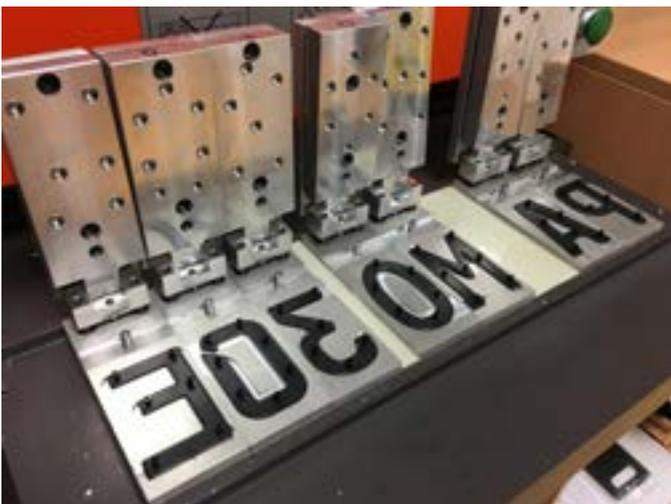
3. Im Anschluss werden die recyclefähigen Kunststofflettern in den Prägewerkzeugen platziert.
