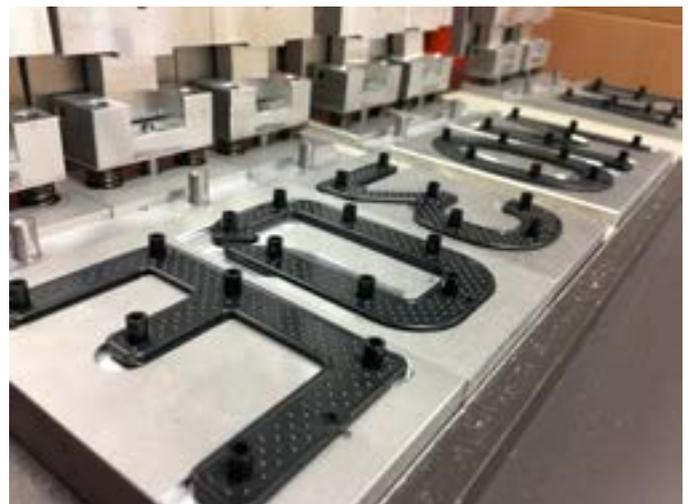
4. Die Kunststofflettern verfügen über Zapfen, die sich beim Prägen in die Kunststoffplatine bohren und durch Druck mit der Platine zusammengefügt werden. So entsteht ein unverwechselbarer „Fingerabdruck“ am Kennzeichen, was die Diebstahlsicherheit erhöht.
