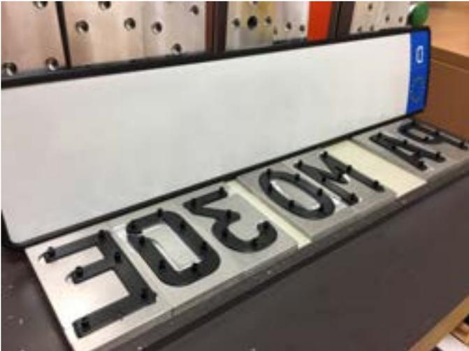
5. Nun wird die Kunststoffplatte aus elastischem Polypropylen optimal ausgerichtet.
