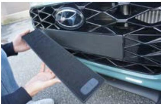
Anschließend wird das mit dem Flausch beklebte 3D Kennzeichen mit dem Klett verbunden. Hier ist darauf zu achten, die beiden Komponenten erst gerade und passgenau auszujustieren und im Anschluss miteinander zu verbinden. Achtung: Klett und Flausch haften extrem stark aneinander und können nach der Verbindung miteinander nicht mehr ohne Werkzeug (Lineal, Angelschnur oder Schaber) voneinander gelöst werden.
